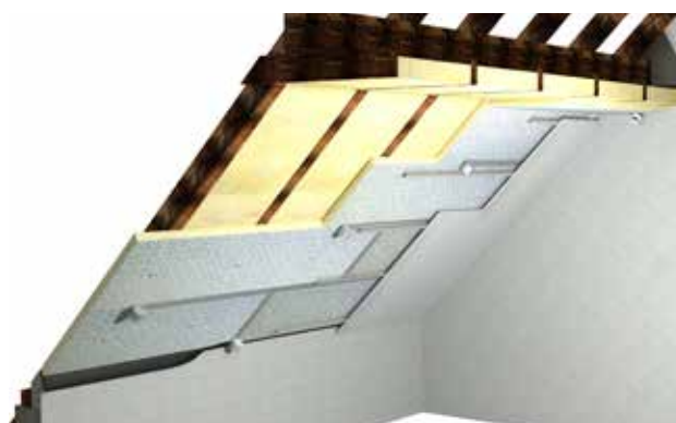
Pokládka izolačních desek a vzduchotěsné lepení spojí izolačních desek. Připevnění vnitřního obložení k latím.
