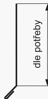
Schéma doplňkového oplechování pod závětrnou lištu (atyp).
