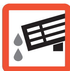
Při skladování vyspádovat pro odtékání vody
